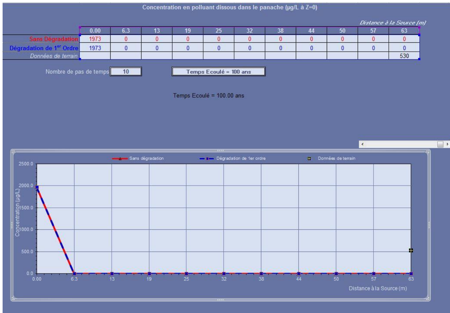
Figure 4 : Résultat de la simulation après 100 ans pour une concentration initiale de 1973.16 µg/L : atténuation de la concentration en zinc dans l'eau souterraine depuis la couche de cendres jusque la limite aval (à hauteur du cours d'eau de l'Attert).
