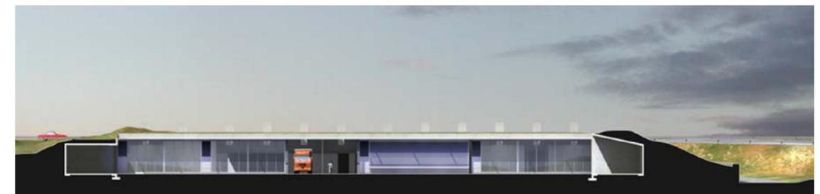
Durch das Anordnen von niedrigeren Räumen an der Peripherie des Gebäudes, werden die Übergänge zum natürlichen Gelände weicher und organischer. So wirkt das Dach als integraler Bestandteil der unbebauten Umgebung.
