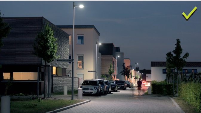
Neuanlage mit LED Mastleuchte: maßvolles Lichtniveau, warm-weiße Lichtfarbe, abgeschirmte, energieeffiziente Leuchte. Foto: Frieder Blickle, WE-EF
