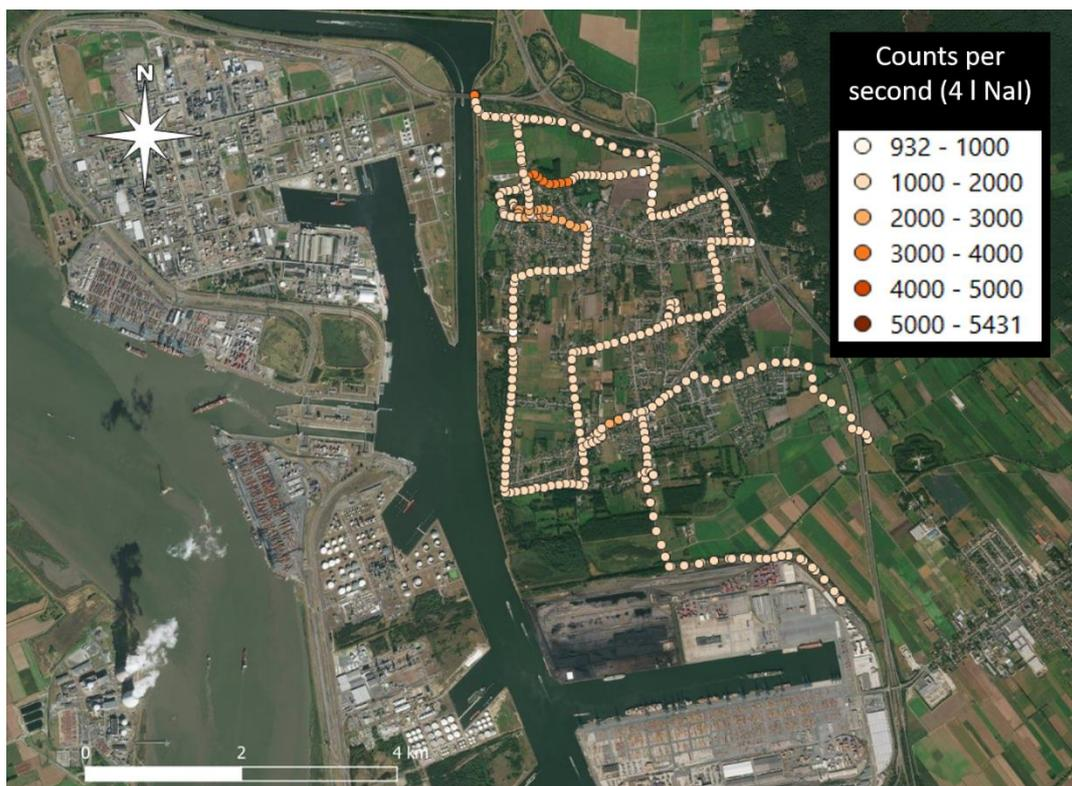
Figure 37 : Campagne de mesure effectuée avec un détecteur de grand volume à bord d'un véhicule dans la région au nord-est de la CNDoeI (mesures SCK CEN, 2020). Les unités de la légende sont spécifiques au détecteur et illustrent uniquement les différences relatives. Les débits de dose normaux sont mesurés sur toute la zone (carte de fond : Bing VirtualEarth).
