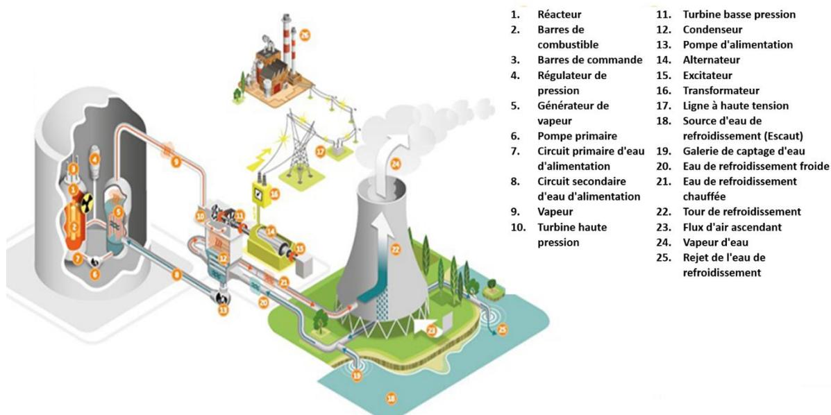
Figure 3 : Fonctionnement de la centrale nucléaire avec, de gauche à droite, le bâtiment du réacteur, la salle des machines et le circuit de refroidissement (Source : Electrabel sa).
