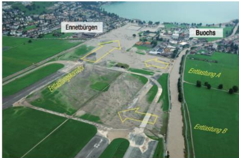
Abbildung 21: Entlastungskorridor der Engelberger Aa, 2005. Quelle: (Grambow, 2013)
