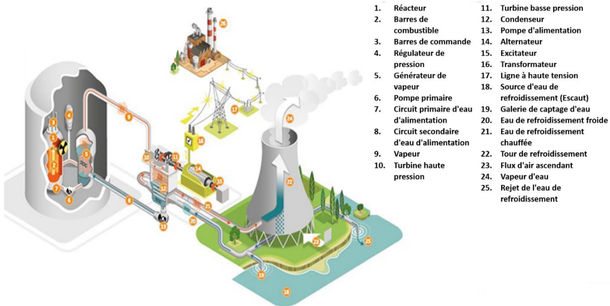
Figure 2 : Fonctionnement de la centrale nucléaire avec, de gauche à droite, le bâtiment du réacteur, la salle des machines et le circuit de refroidissement (Source : Electrabel sa).
