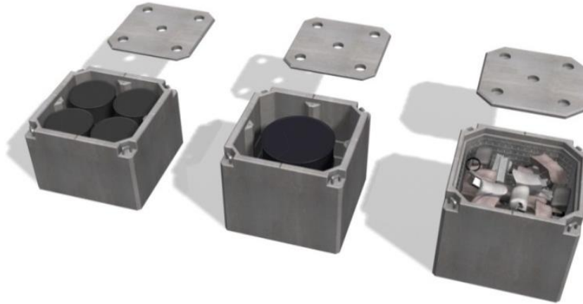
Figure 27 : Illustrations des trois types de caissons vi à déchets : type I (gauche), type II (milieu) et type III (droite). Après mise en place du couvercle et remplissage de l'espace entre les déchets et le caisson par du mortier, ces colis sont appelés « monolithes ».
