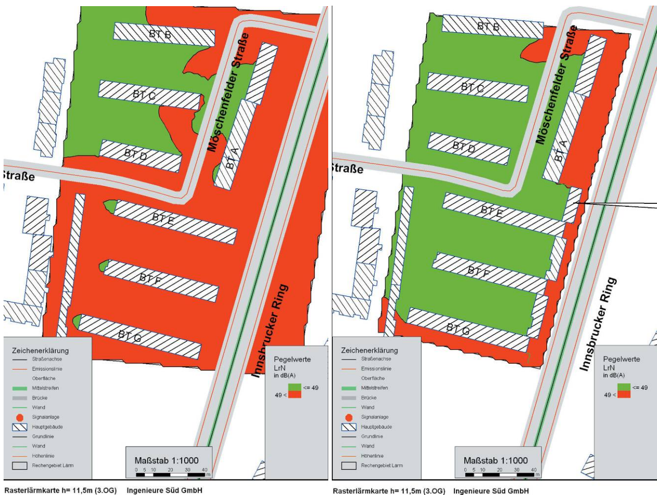
Abb. 86: Lärmbelastung vor und nach den Schallschutzmaßnahmen (Felix + Jonas Architekten)
