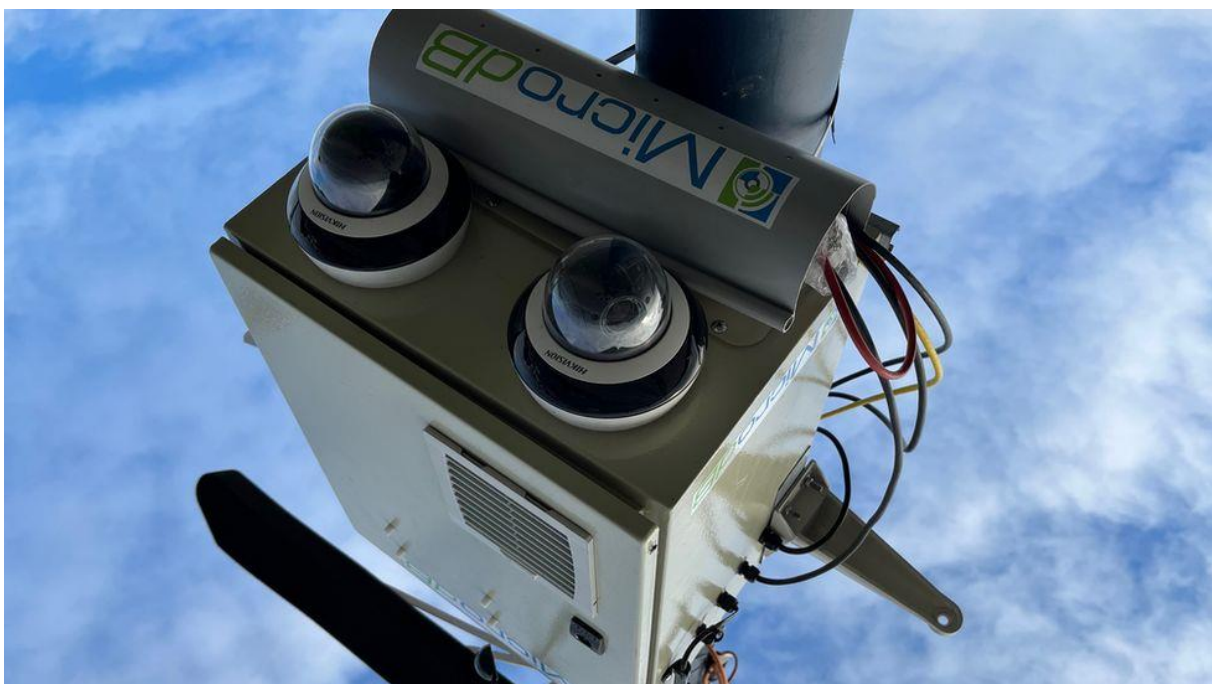
Abbildung 5: Lärmkamera von MicrodB
