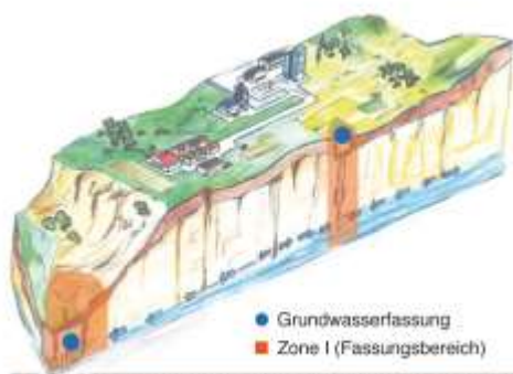
GRUNDWASSERFASSUNG UND EINTEILUNG DER ZONE I
