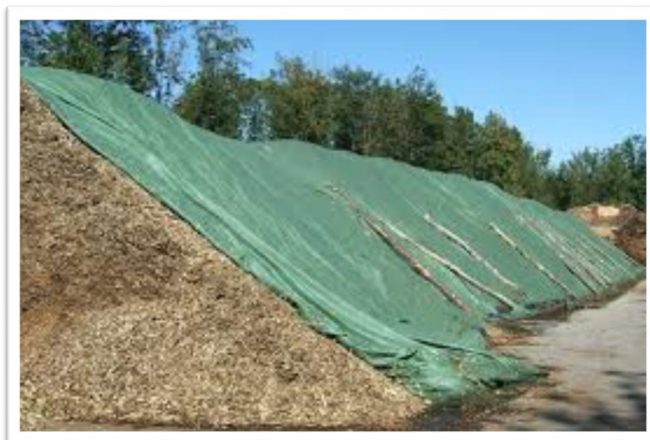
Abbildung 59: mittels Membranfolie abgedecktes Brennstofflager
