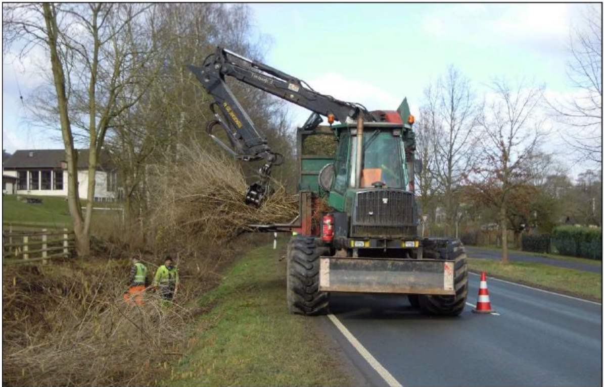
Abbildung 16: Zerkleinerung und Häcksel-/Hackgutaufnahme mit Forwarder-Geräteträger 26
