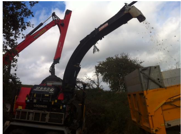
Abbildung 31: Direktverladung von Häckselmaterial (SICONA)
