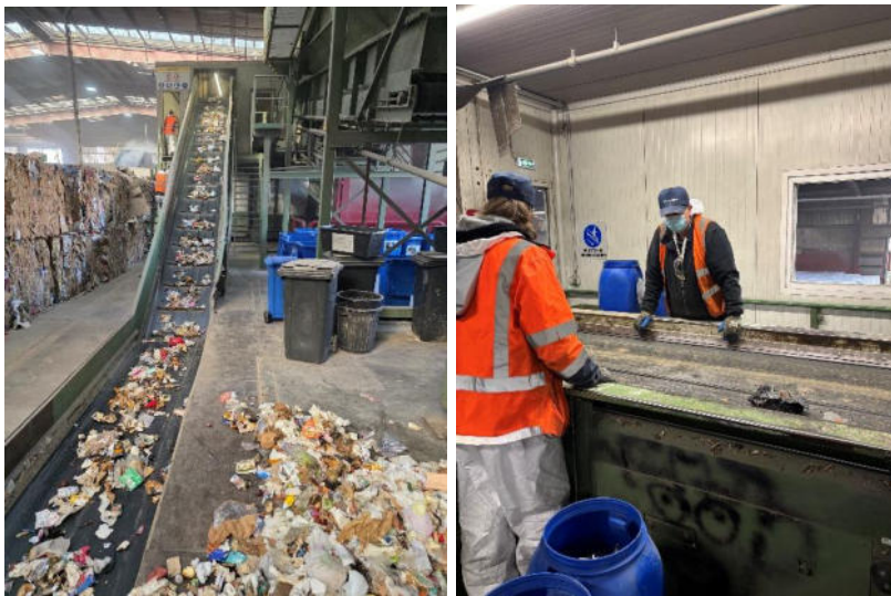
Abbildung 7: Händische Sortierung (linear) in einer Sortierkabine der Fa. Lamesch-Prezero
