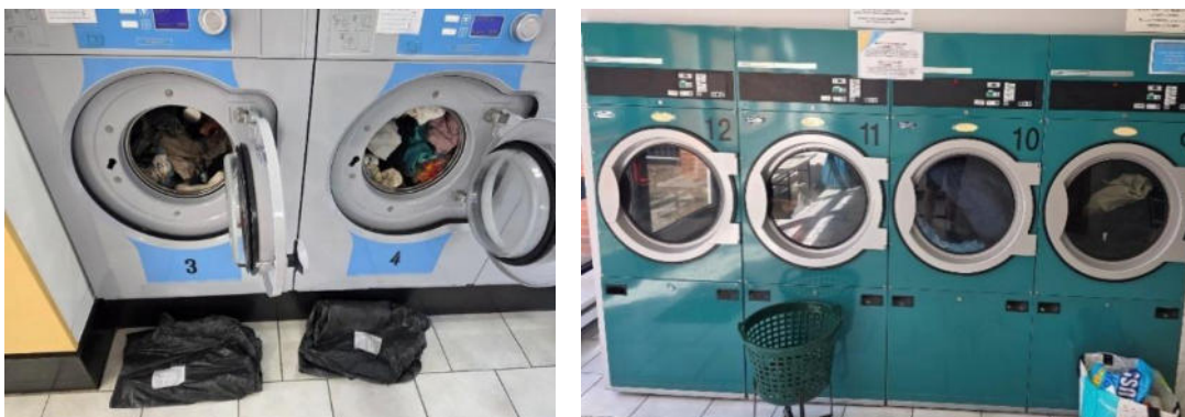
Abbildung 34: Wäsche und Trocknung der Sortierfraktion Bekleidung (SF 23A) in kommerziellen Großgeräten
