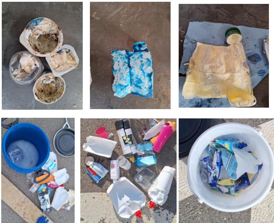
Abbildung 29: Waschen und Trocknen von ausgewählten Kunststofffraktionen sowie Bestimmung Anteil von Kleber und Etiketten
