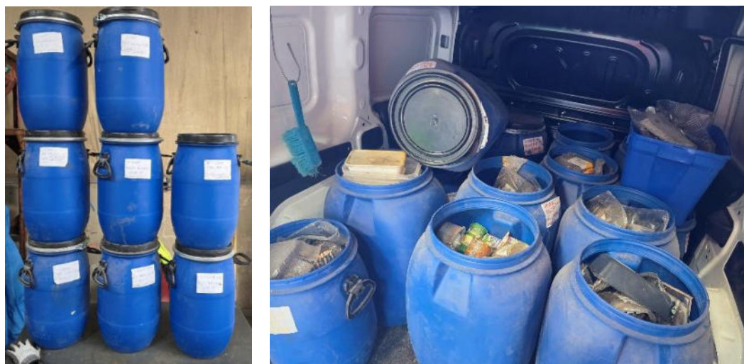
Abbildung 28: Stichproben zur Bestimmung von Verschmutzungsgrades in ausgewählten Kunststofffraktionen
