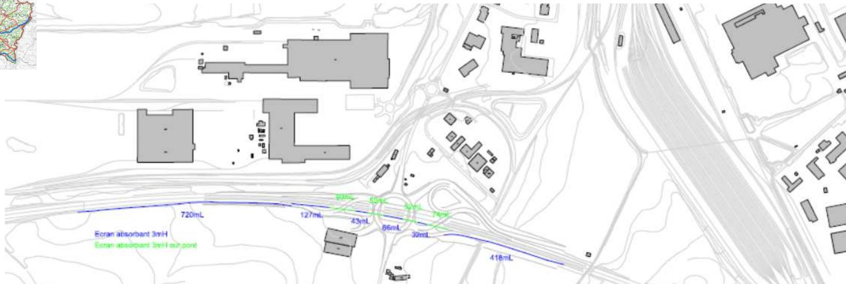
Dans le cadre du réaménagement de l'échangeur de Burange, des écrans de protection d'une hauteur de 3.0 m seront mis en oeuvre au Sud de la A13.
