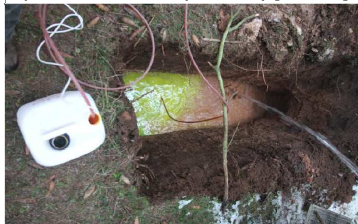
Injection d'uranine dans une fouille – Traçage à Mertzig
