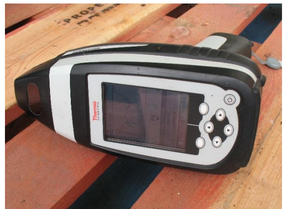
Bild :60 Materialspezifische Untersuchung Nahinfrarotspektrometer (microPHAZIR)
