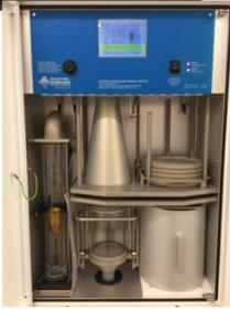
Pour séparer les différentes fractions de poussières fines, les appareils disposent d'une tête de prélèvement sélective de fraction granulométrique. Pour cette campagne on a utilisé une tête de prélèvement permettant l'échantillonnage des particules ayant un diamètre aérodynamique inférieur à  $10 \mu m$  ( $PM_{10}$ ).
