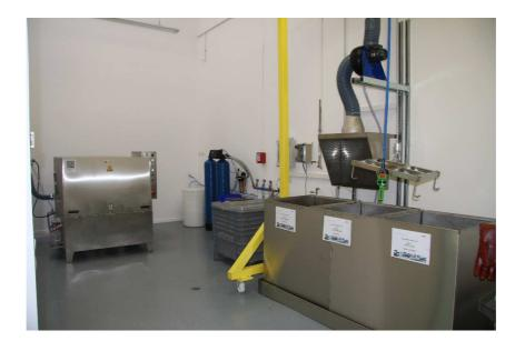
Suite au décapage, les pièces repasseront dans l'installation de nettoyage pour nettoyage et séchage et sont ensuite transférées vers l'une des trois affuteuses qui seront mises en œuvre pour être retravaillées.
