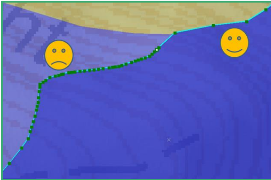
Abb. 6-2: Unangemessene Häufungen Stützpunkten bzw. Knoten müssen vermieden werden
