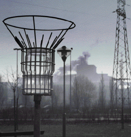
Figure 4 : Dispositif de collecte (support et bocal) des retombées de poussière - Réseau Bergerhoff à Esch/Alzette
