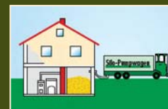
Remplissage en granulés de bois à l'aide d'un camion-citerne
