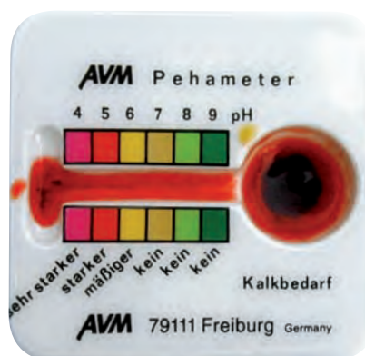
Analyse de pH au moyen d'un test colorimétrique (pH mesuré de 5)
