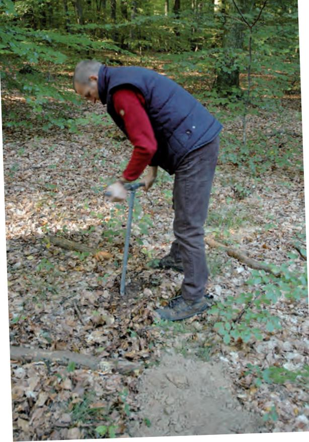
Entnahme einer Bodenprobe mit dem Erdbohrer
