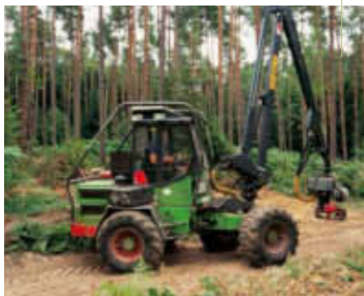
LE « PROCESSEUR » SAISIT UNE TIGE ABATTUE, L'ÉBRANCHE ET LA FAÇONNE
