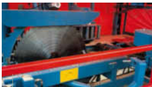
SCIE CIRCULAIRE SIMPLE POUVANT ÊTRE UTILISÉE POUR LE DÉBIT DU BOIS ROND DE QUALITÉ COURANTE
