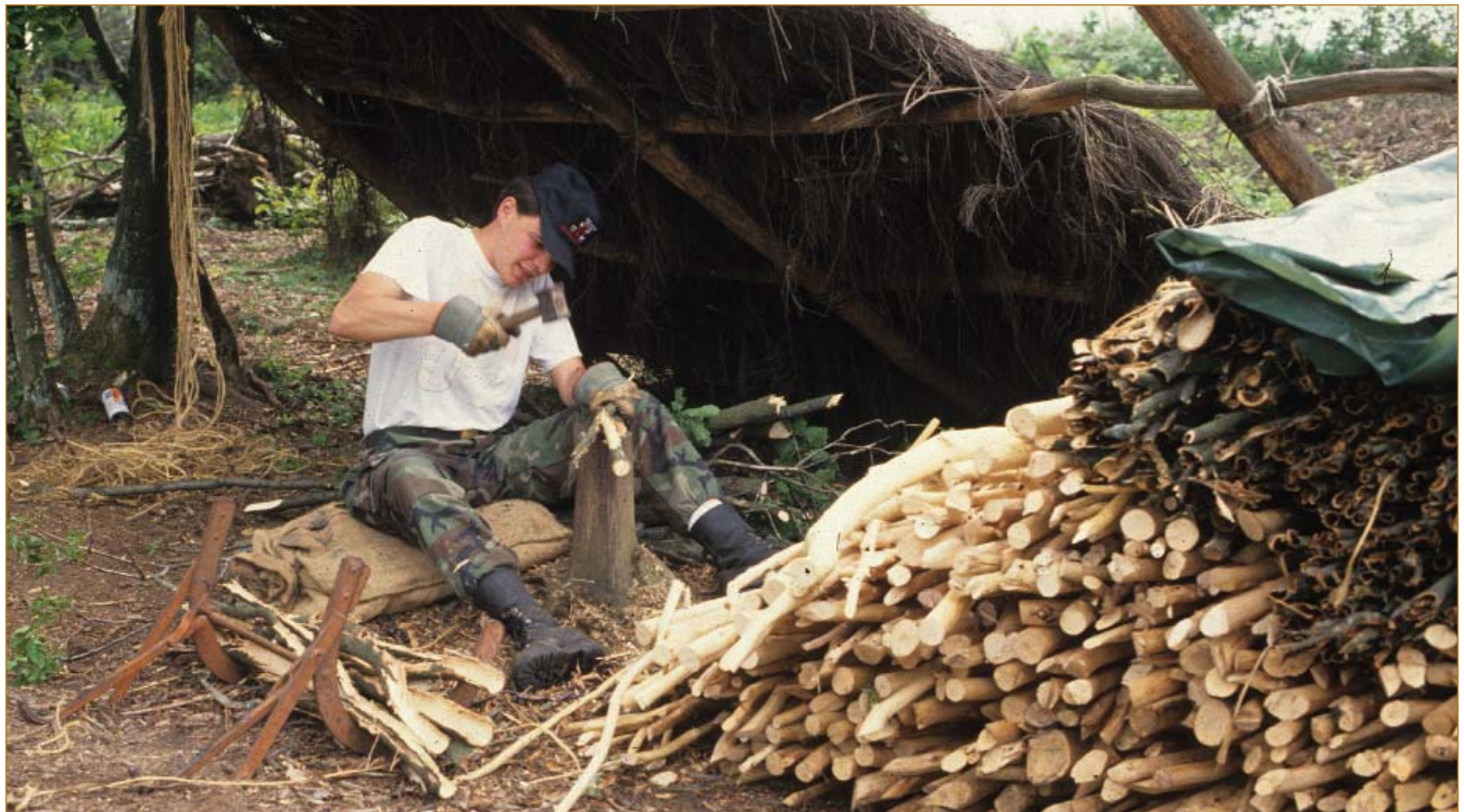
Das Entrinden der "Loukleppel" mit einem Hammer und einem Stein als Unterlage
